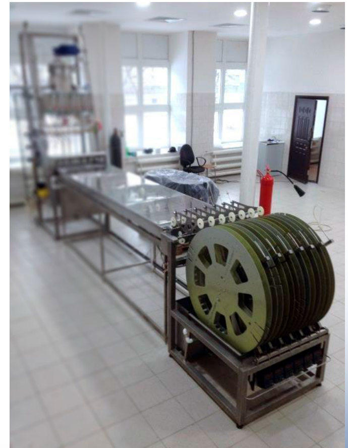
Линия формования полых волокон для газоразделения (включает 7 независимых линий протяжки)
