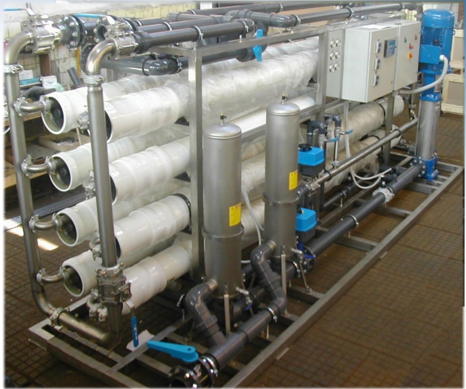
Установка обратного осмоса для паровых автоклавов, 30 м³/час, компания Марс, Россия
