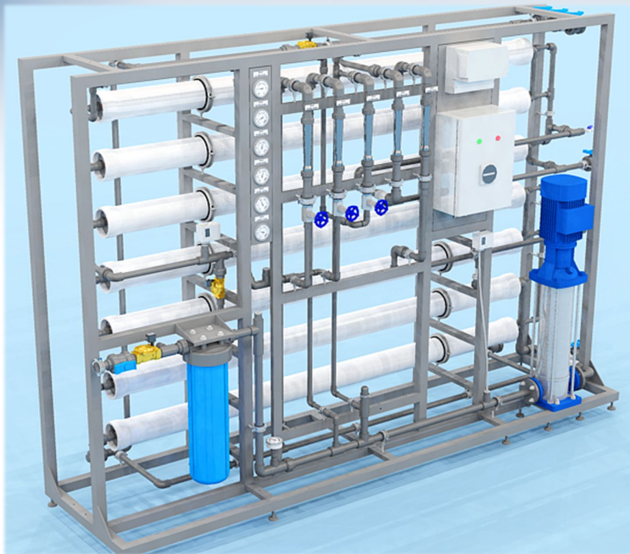
Обратноосмотическая двухступенчатая установка опреснения воды, 30 м 3 /сут, для ФГУП «Гознак»
