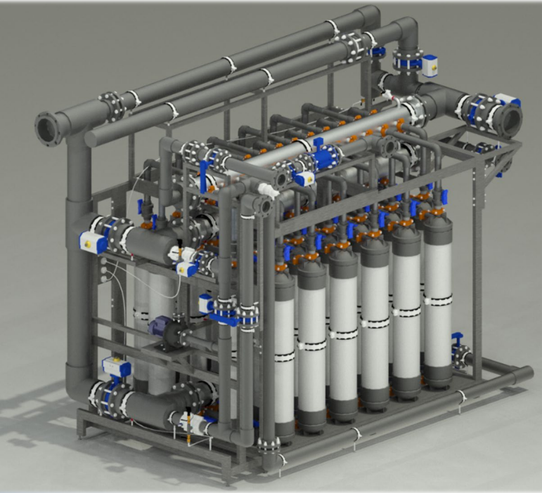
Блок ультрафильтрации 65 м³/ч для предварительной очистки воды
